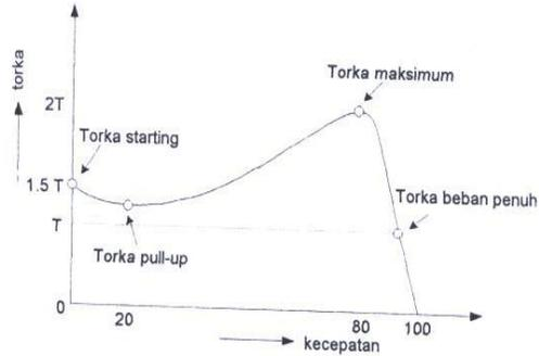
Gambar 3. Karakteristik Torka-Kecepatan Motor Induksi Tiga Fasa
