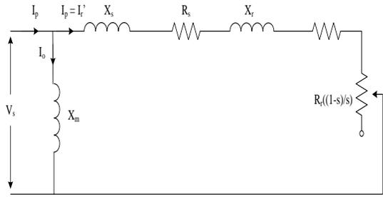
Gambar 1. Pendekatan Rangkaian Ekuivalen Motor Induksi Tiga Fasa
