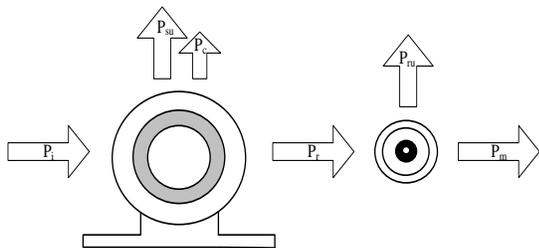
Gambar 2. Aliran Daya Aktif Motor Induksi Tiga Fasa
